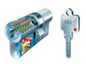
C 41 Geprüft nach DIN EN 1303 und DIN 18252. Serienmäßig geschützt gegen Schlagpicking. Halbzylinder, Gleichschließung und Drehkopf innen möglich. Der Bohrmulden- schlüssel garantiert einen effektiven mechanischen Kopierschutz. Mit Sicherungskarte.
